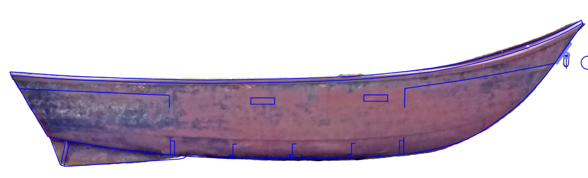
Afbeelding 17 Projectie van de lengte doorsnede over de foto van het zijaanzicht.
